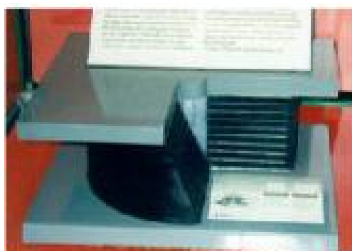
Εικόνα 9: Ελαστομερές Εφέδρανο με πυρήνα μολύβδου
