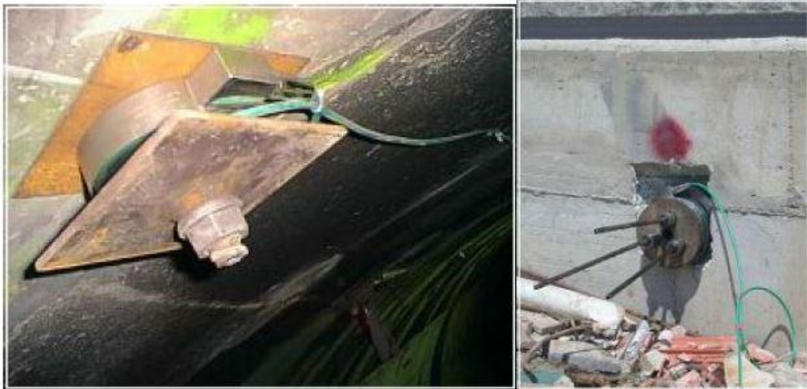
Σχήμα Εγκατάσταση μετρητού φορτίου σε αγκύριο βράχου (SISGEO Co.).
