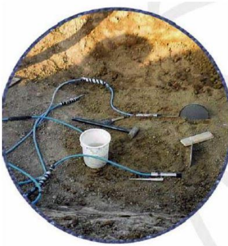
Σχήμα . Κυψέλες μέτρησης φορτίων (Soil Instruments Ltd.)
