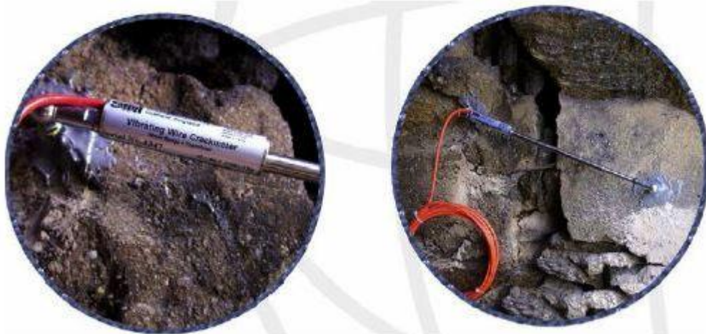
Σχήμα : Μέτρηση πάχους ρωγμής (Soil Instruments Ltd.)
