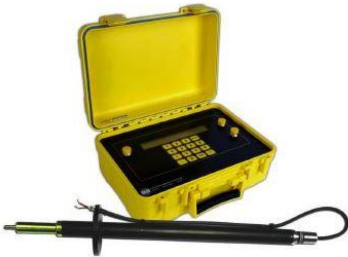
Σχήμα : Παρουσίαση επιμηκυνσιόμετρου (Soil Instruments Ltd).
