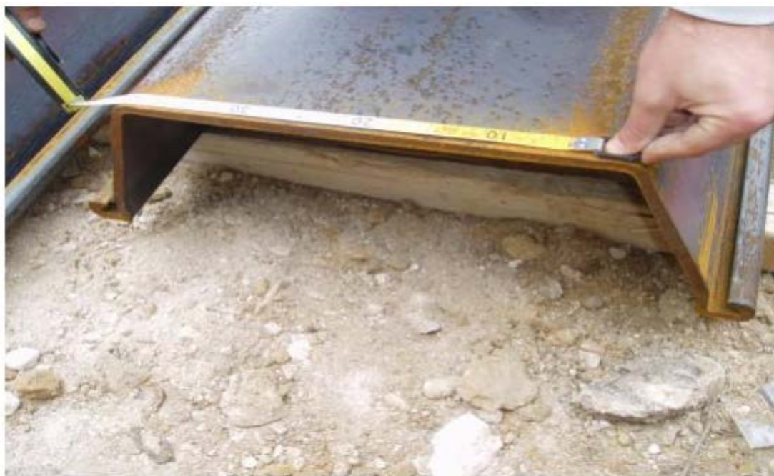
Εικόνα 4.12:Πραγματική απεικόνιση πασσαλοσανίδας.
