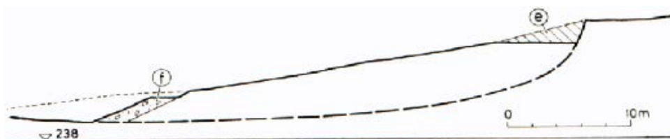
Εικόνα 2.12: Αστοχία πρανούς από εκσκαφή στη βάση του για διάνοιξη οδού.
