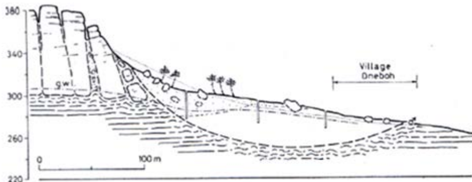
Εικόνα 2.4: Κατολίσθηση από μάργες και αποσαθρωμένα υλικά.
