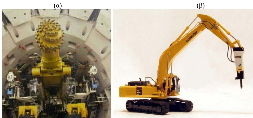
Εικόνα 5.7: α) Μηχάνημα σημειακής κοπής. β) Πνευματικό σφυρί.
