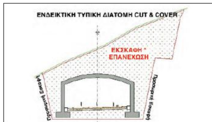
Σχήμα 1.28: Διατομή CUT & COVER
