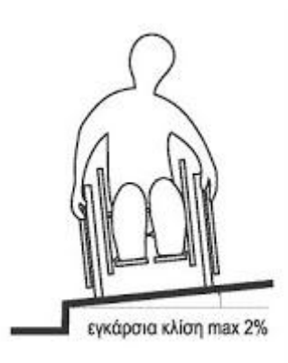
Σχήμα 1.15: Μέγιστη Κλίση Πεζοδρομίου
