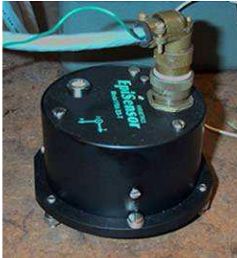
Εικόνα 2.10. Επιταχυνσιογράφος μεταβαλλόμενης δύναμης εξισορρόπησης. [1]
