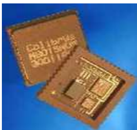
Εικόνα 2.7. Τυπικός επιταχυνσιογράφος πυκνωτών (Capacitive accelerometer, MEMS Manufacturer/ XS 8000 family). [1]
