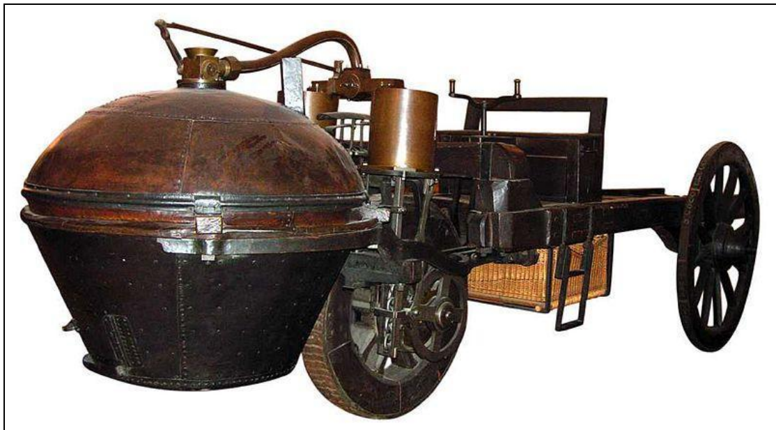
Εικόνα 33. Αναπαράσταση της τρίτροχης ατμομηχανής του Nicolas-Joseph Cugnot, 1769.
