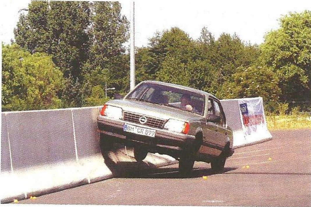
Εικόνα 5.1: Πρόσκρουση επιβατικού οχήματος σε στηθαίο σκυροδέματος με διατομή New Jersey.
