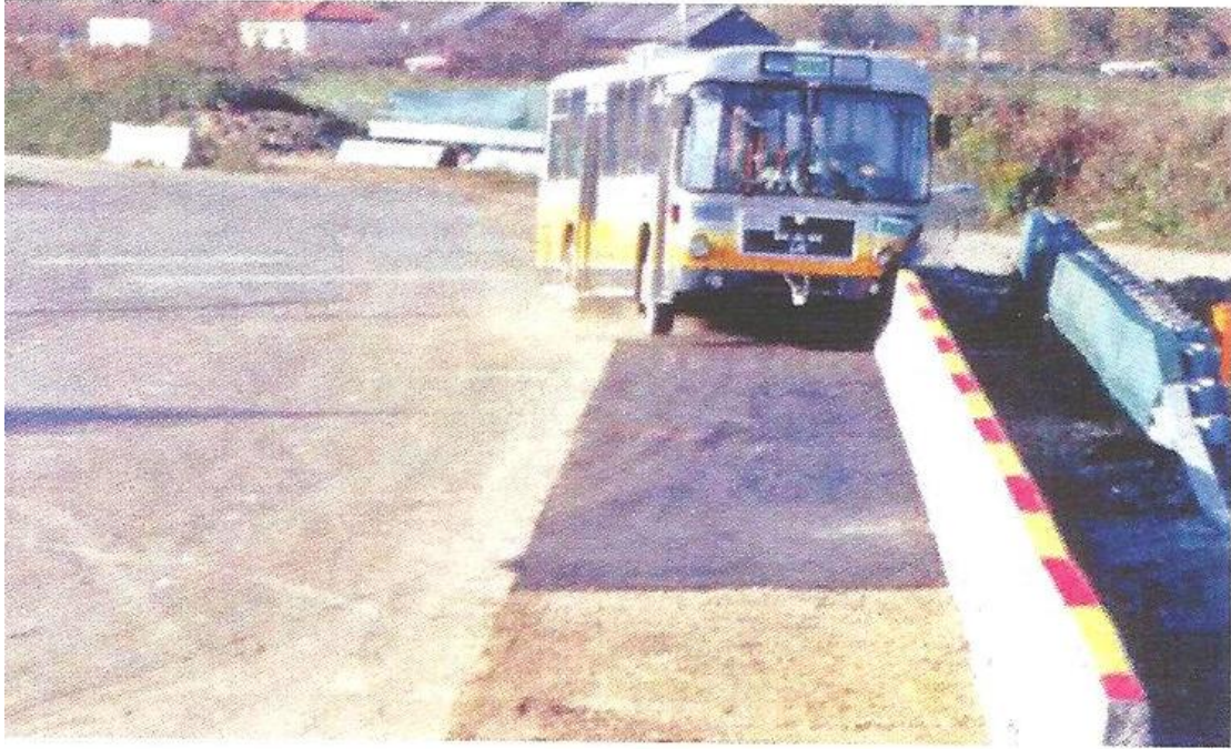
Εικόνα 5.2 Πρόσκρουση λεωφορείου σε στηθαίο σκυροδέματος με διατομή New Jersey.
