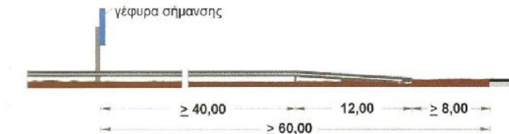
Εικόνα 4.10: Μεταλλικά στηθαία ασφάλειας σε νησίδα διαχωρισμού κλάδων.
