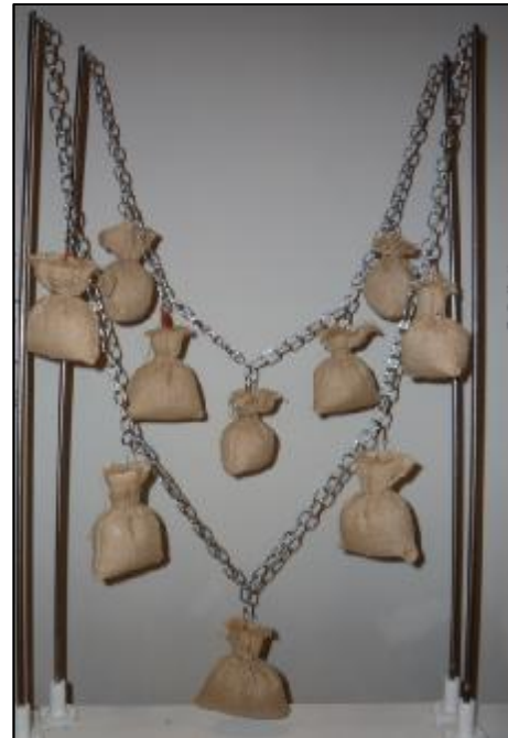
Εικόνα 113 Μοντέλο φορτίων. Το ίδιο βάρος που κρέμεται από τη μικρότερη αλυσίδα προκαλεί τη δομή στήριξης για τόξο προς τα μέσα. Gaudi Centre, Reus
