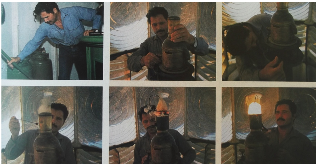
Εικόνα 48:Το οπτικό σύστημα του φάρου Παππά στην Ικαρία. Η αφή με πετρέλαιο. Πηγή: ‘ Ο Φάρος των Ανέμων. Παππάς Ικαρίας’,Εφοπλιστής, τεύχος 91. 2000
