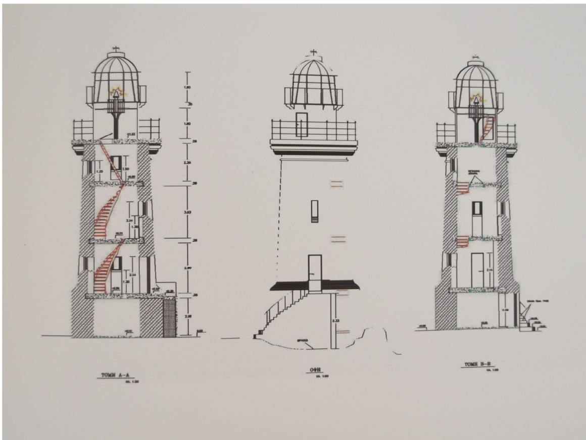
Εικόνα 80:1,2,3 Αρχιτεκτονικά σχέδια του φάρου της Πάφου
