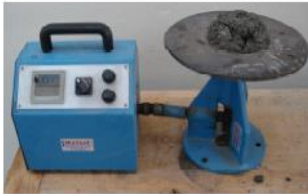
Εικόνα 3.2. Συσκευή δοκιμής εξάπλωσης [1].
