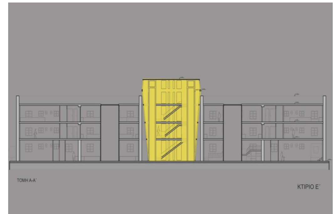
Εικόνα 56: Νέα μεταλλική κατασκευή εντός του κελύφους
