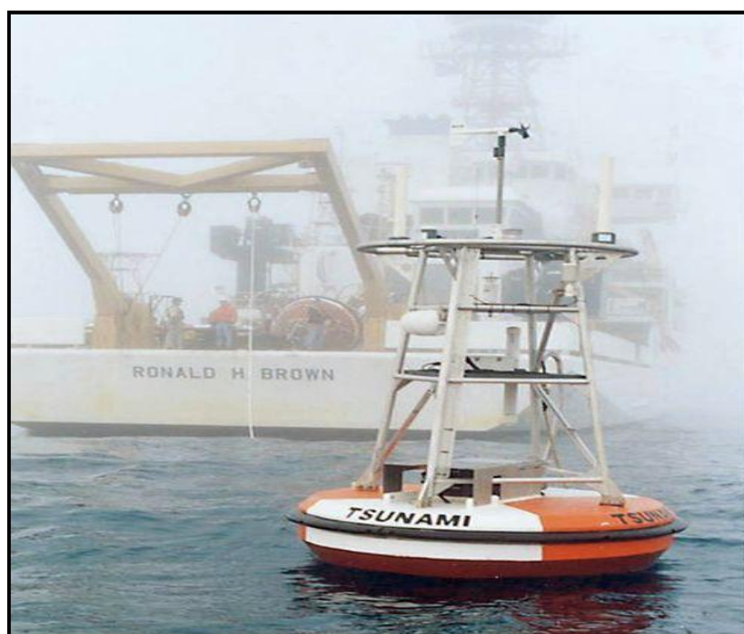
Εικόνα 1.6 Σημαντήρας υδάτων συστήματος προειδοποίησης DART
