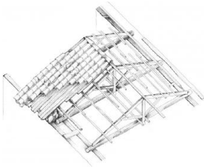
Εικόνα 27: Αξονομετρική τομή στέγης (σκίτσο)
