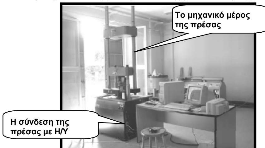
(Η πρέσα του εργαστηρίου σκυροδέματος / νέας τεχνολογίας)
