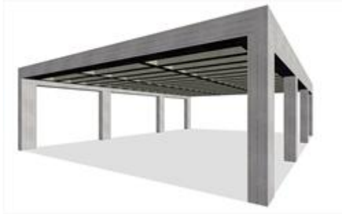
Δοκιδωτή πλάκα μίας κατεύθυνσης
