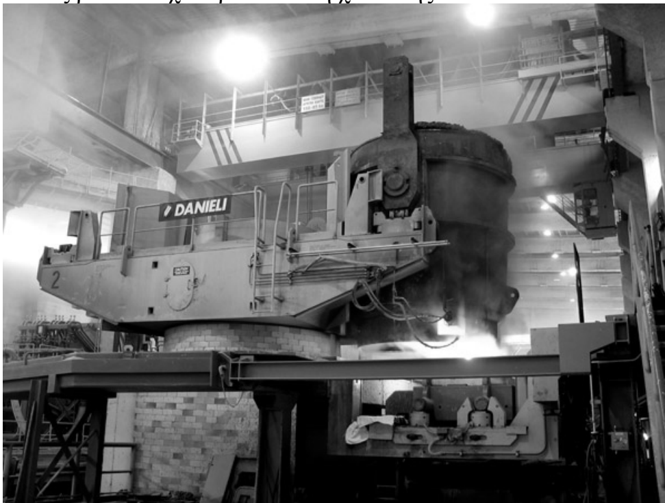
Κάδος ρευστού χάλυβα σε θέση χύτευσης
