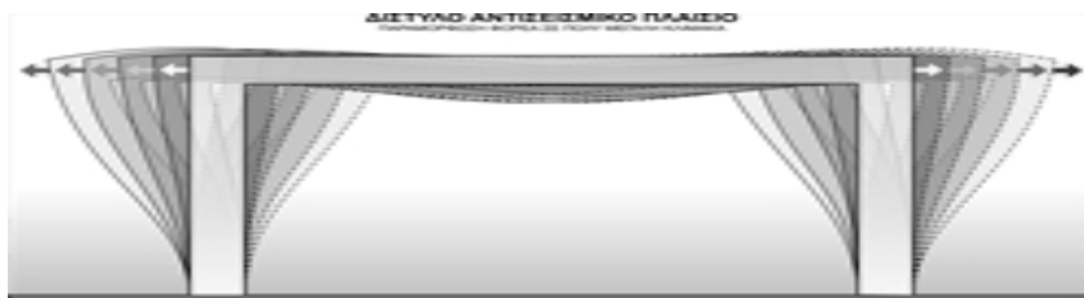
Παραμόρφωση πλαισίου σε σεισμό
