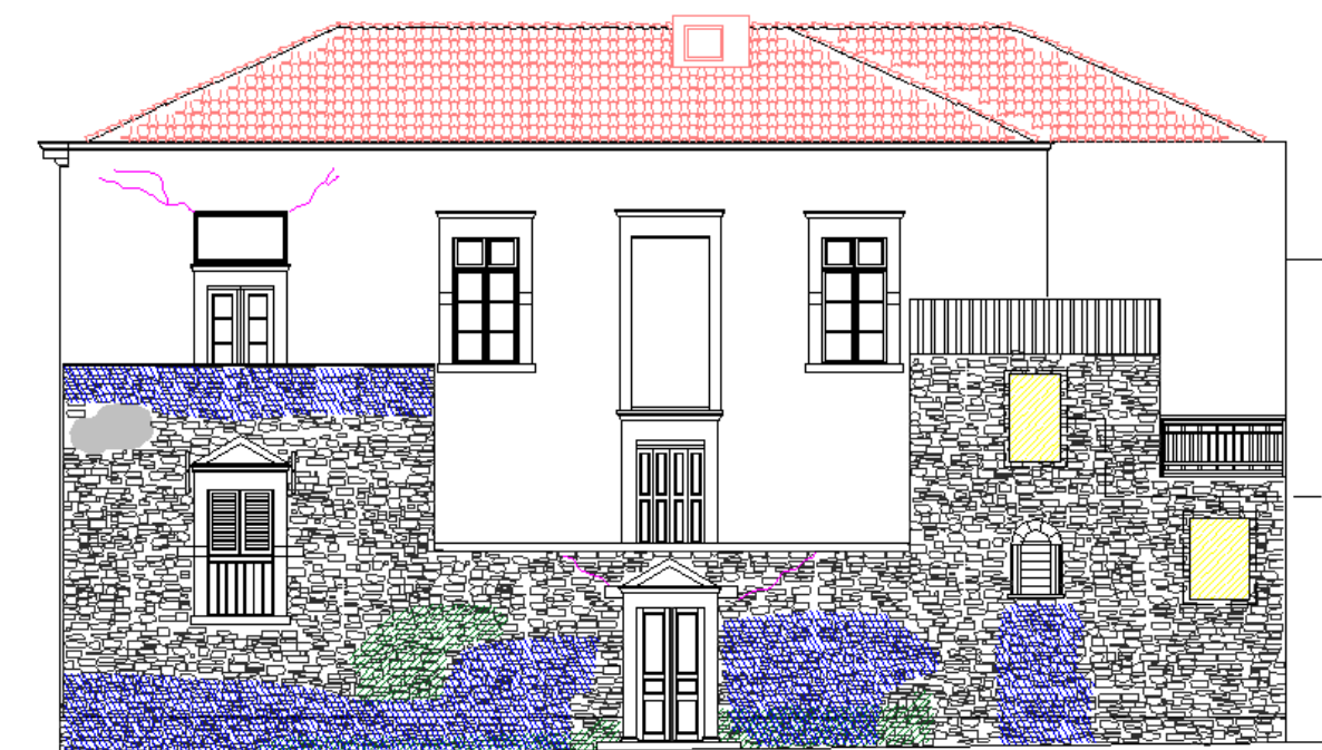
Εικόνα 20 Δυτική όψη του κτίσματος. Με μπλε σκιάζονται τα σημεία όπου σημειώνεται απώλεια κονιάματος. Με κίτρινο σκιάζονται τα σημεία όπου έχουν τοιχιστεί ανοίγματα. Με πράσινο τονίζονται τα σημεία όπου παρατηρείται ρηγμάτωση και αποσάθρωση λίθου. Και τέλος με γκρι είναι υπολείμματα επιχρίσματος.
