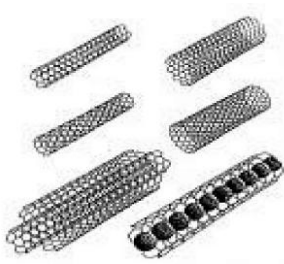
Εικόνα 2. 2 α & β: CNT με ένα ή περισσότερα τοιχώματα
