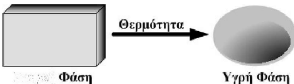
Εικόνα 3. 16: Μεταβολή φάσης του υλικού κατά την πρόσληψη θερμότητας.
