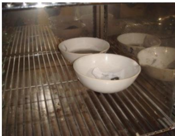
Εικόνα 2.31: Το υλικό που έχει συλλεχθεί μετά το πλύσιμο και τοποθετείται στον φούρνο.
