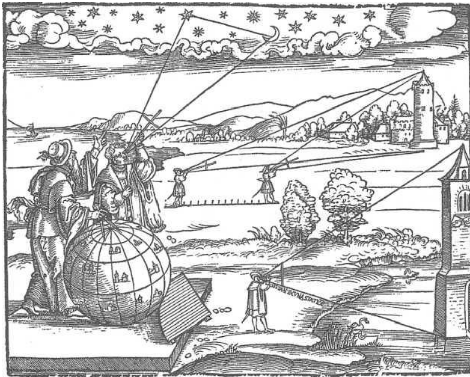
Εικόνα 50. Ο εγκάρσιος πήχης σε αστρονομικές (radius astronomikus) και σε τοπογραφικές εφαρμογές (radius geometricus), για τη μέτρηση αποστάσεων και υψομετρικών διαφορών. Η μέτρηση της απόστασης μεταξύ της Σελήνης και ενός αστέρα σχετίζεται με το πρόβλημα του προσδιορισμού του γεωγραφικού μήκους.
