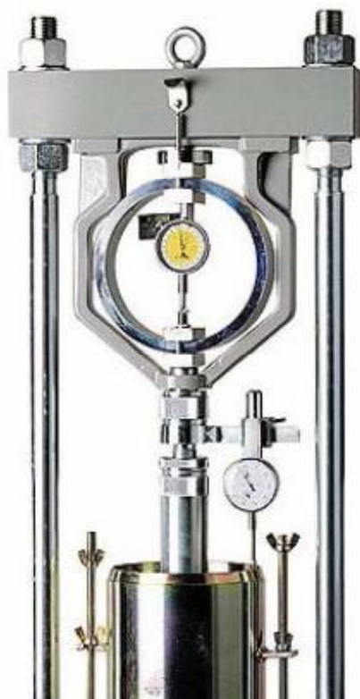
Εικόνα 4.3 : Συσκευή για τη μέτρηση της διόγκωσης.
