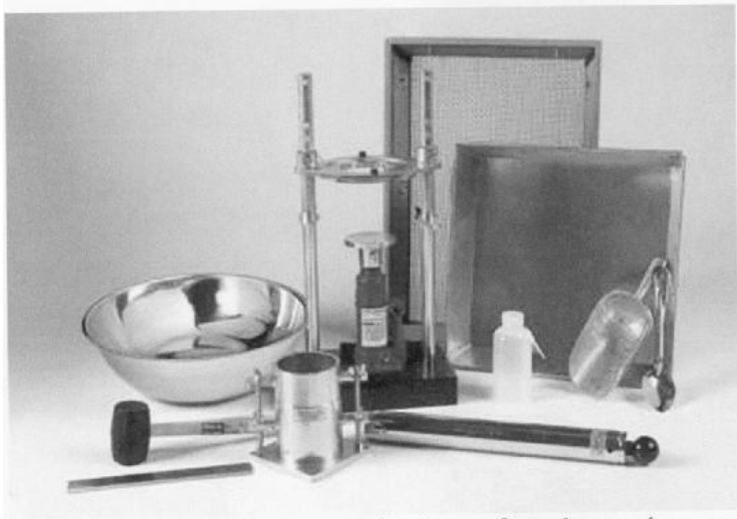
Εικόνα 2.1 : Εξοπλισμός για την επίτευξη της δοκιμής συμπίκνωσης κατά Proctor.
