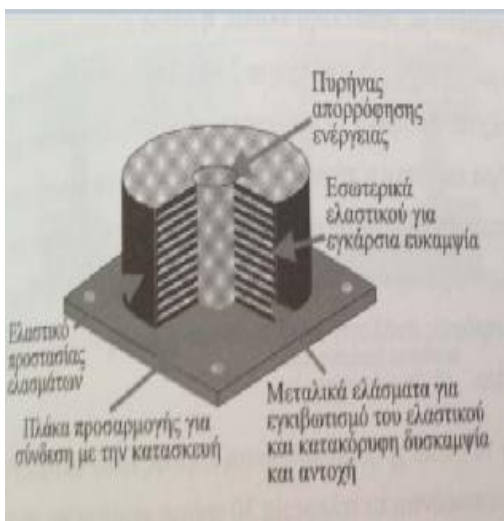
Σχήμα 1.3.12 : Ελαστομεταλλικά εφέδρανα : (i) σχηματική τομή, (ii) εφέδρανο σε στήριξη γέφυρας [Δ. Θεοδωρακόπουλος, κλπ., 2003]
