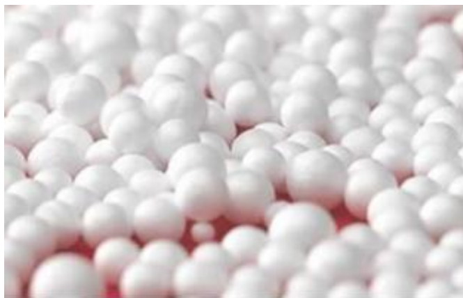
Σχήμα 2.8 Κόκκοι διογκωμένης πολυστερίνης
