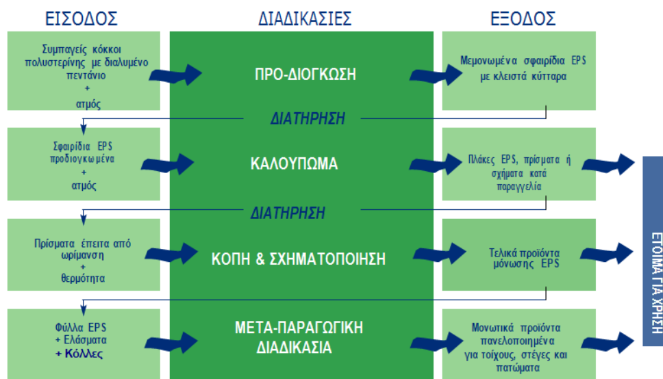
Σχήμα 2.7 Σχεδιάγραμμα της παραγωγικής διαδικασίας του γεωαφρού EPS
