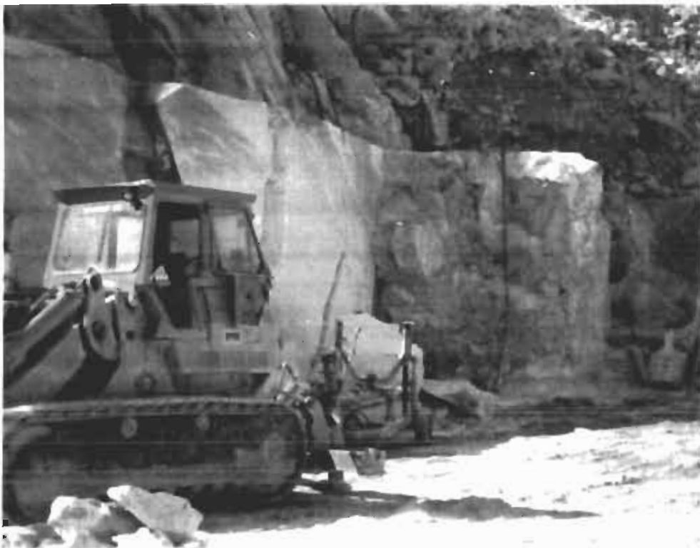
Φώτο Νο 4: Πρωθητής γαιών και Wagon Drill 692 της Benetti Machine
