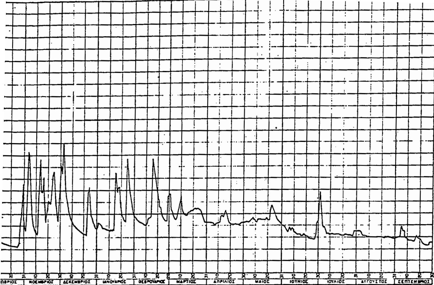
ΑΧΕΛΩΣ ΕΙΣ ΚΡΕΜΑΣΤΑ - ΔΙΑΓΡΑΜΜΑ ΗΜΕΡΗΣΙΑΣ ΣΤΑΘΜΗΣ - ΥΔΡΟΛΟΓΙΚΟΝ ΕΤΟΣ 1956-1957
