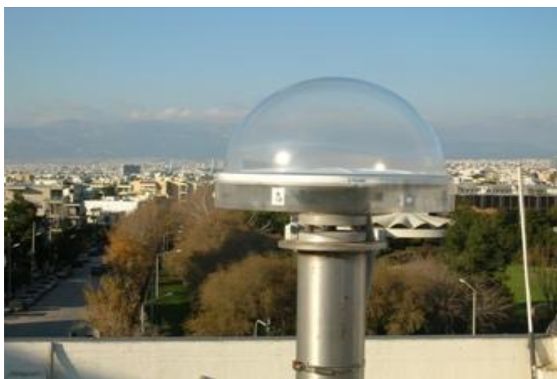
Εικόνα 3.2: Αντένες Trimble Zephyr Geodetic με θόλο
