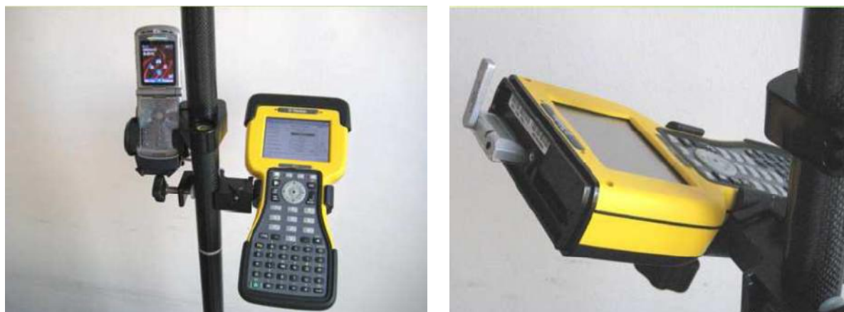
Εικόνα 5.2α,β: Σύνδεση στο κέντρο ελέγχου του HEPOS: α) μέσω κινητού τηλεφώνου, και β) μέσω compact flash κάρτας GSM/GPRS.
