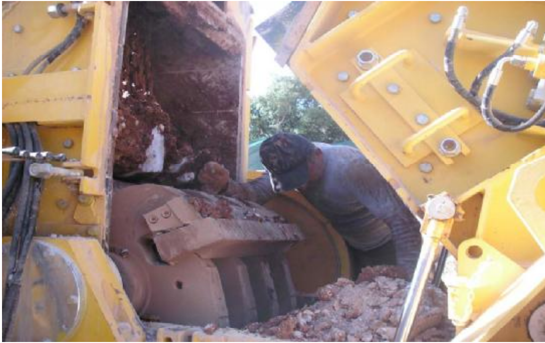
Πρόβλημα στο Θώρακα του Σπαστήρα 1
