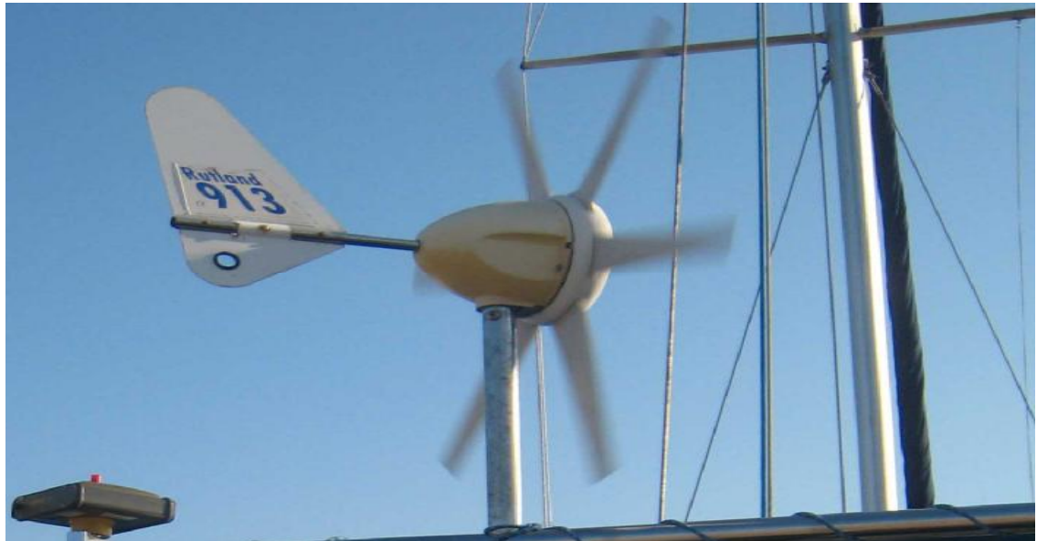
Εικόνα 7.4- Ανεμογεννήτρια τύπου Rutland για την παροχή ενέργειας στους συσσωρευτές του σκάφους αλλά και στο δέκτη GPS κατά τη διάρκεια των πειραμάτων.
