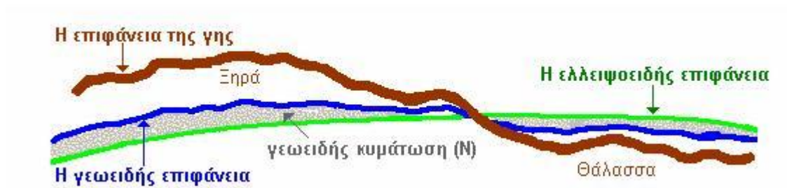
Εικόνα 1.2- Η επιφάνεια της γης σε σχέση, με τη γεωειδή και ελλειψοειδή επιφάνεια.
