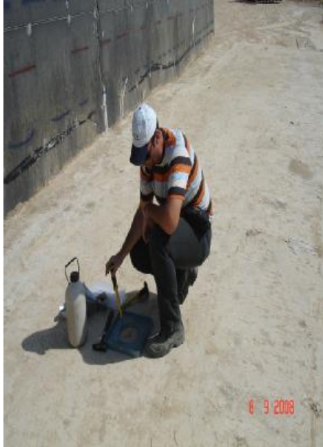
Εικόνα 20 και 21 φώτο από την επί τόπου εργοταξιακή δοκιμή με μέθοδος κώνου και άμμου
