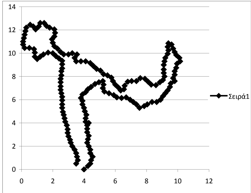
Σχήμα 17. Γραφική παράσταση του ταμιευτήρα του φράγματος μέσω Excel με τη χρήση των συντεταγμένων x,y.
