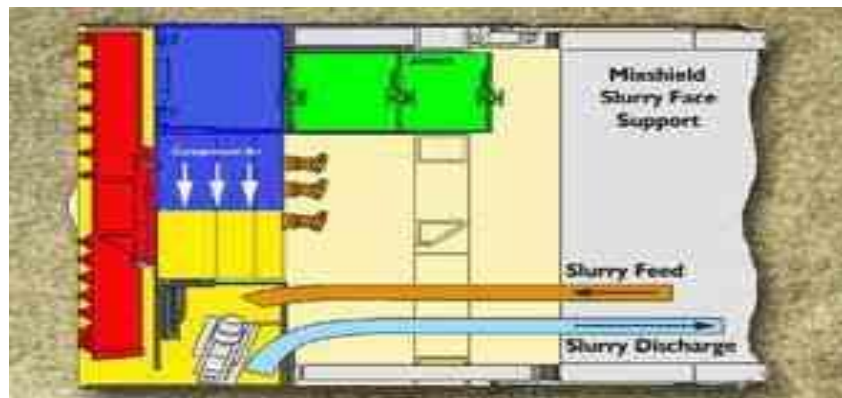
Σχηματική Διάταξη (ολομέτωπης κοπής πολφού ύδατος)
