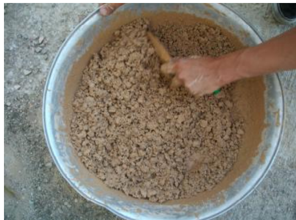
Για τον προσδιορισμό της βέλτιστης υγρασίας αναμιγνύουμε το εδαφικό υλικό με νερό
