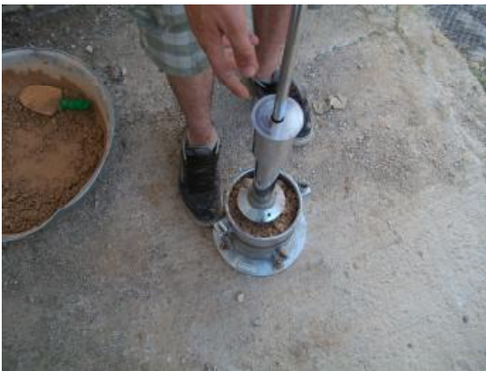
Συμπυκνώνουμε το έδαφος σε 5 στρώσεις εδαφικού υλικού
