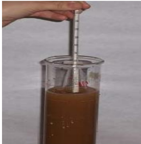
Τοποθετούμε το πυκνόμετρο στον ογκομετρικό κύλινδρο ώστε να πάρουμε της απαραίτητες μετρήσεις
