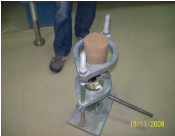
Με τη βοήθεια του εξολκέα βγάζουμε το δείγμα
