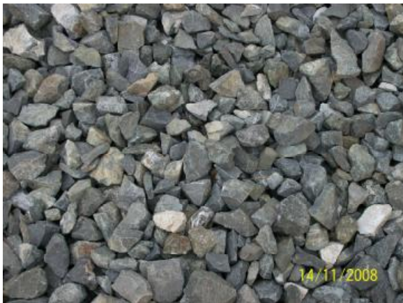
Δείγμα κατάλληλο για τη δοκιμή Los Angeles πριν το κοσκίνισμα
