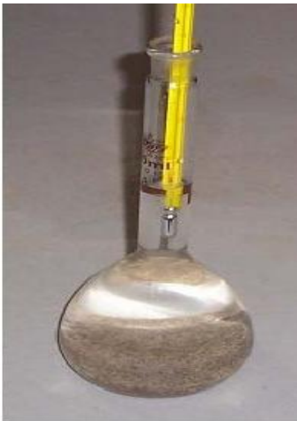
Έχουμε γεμίσει την φιάλη με νερό και μετράμε την θερμοκρασία της
