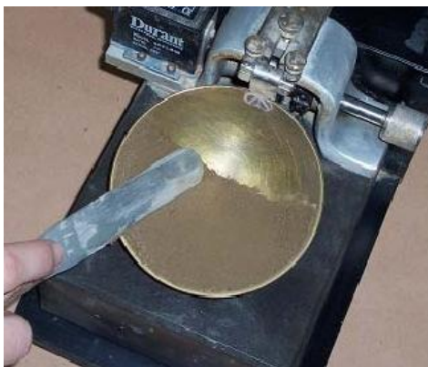
Γεμίζουμε την κάψα της συσκευής με εδαφικό υλικό και συμπιέζουμε ώστε να μην υπάρχουν κενά
