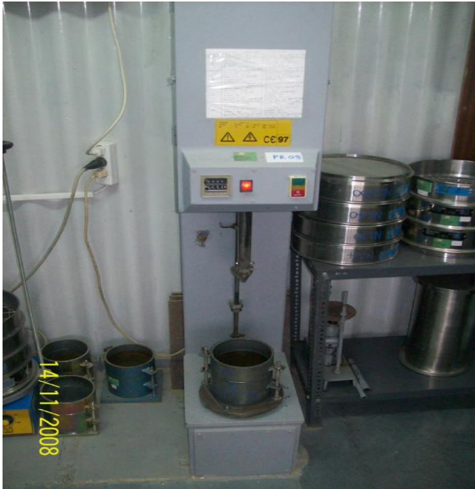
Μηχανή αυτόματης συμπύκνωσης Proctor (στο πάνω μέρος φαίνεται ο μετρητής χτύπων)
