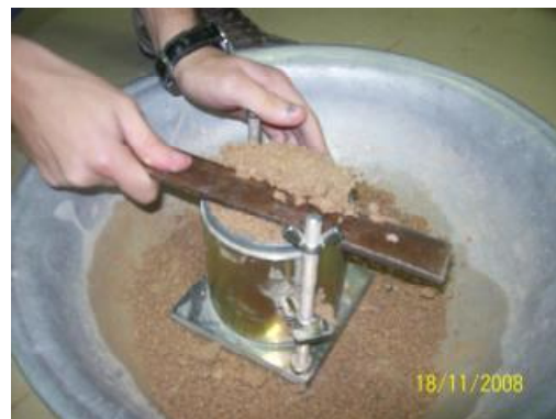
Μετά την τελευταία συμπύκνωση αφαιρούμε με τον κανόνα το εδαφικό υλικό που περισσεύει
