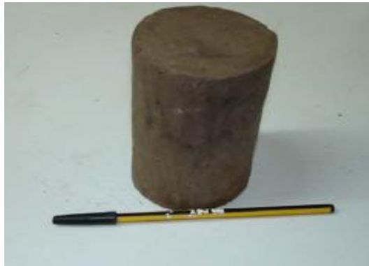
δείγμα αδιατάρακτου εδαφικού υλικού
