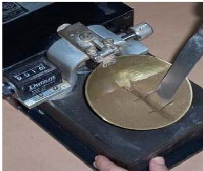
Η ένωση της προηγούμενης εγκοπής και η παραλαβή δείγματος για τον κλίβανο ξηράνσεως
