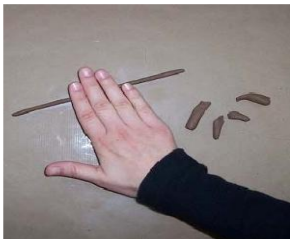
Μετατροπή του υλικού σε μακρόστενη κυλινδρική μορφή για τον προσδιορισμό του ορίου πλαστικότητας
