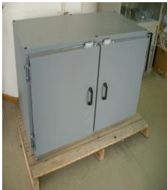
Κλίβανος ξηράνσεως όπου τοποθετήσαμε τα δείγματα για να ξηραθούνε
