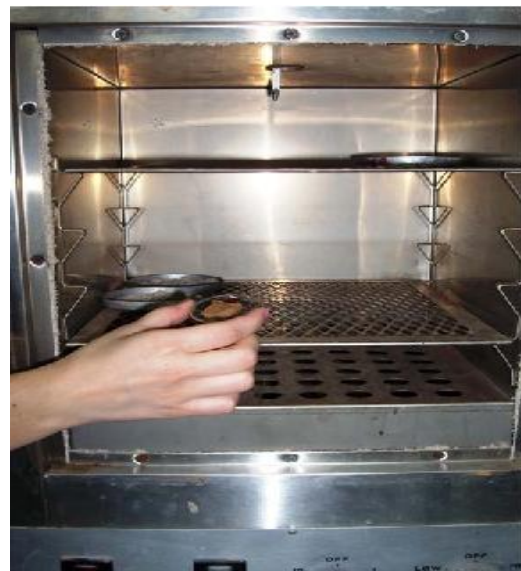
Τοποθετούμε της κάψες με τα δείγματα στον κλίβανο
