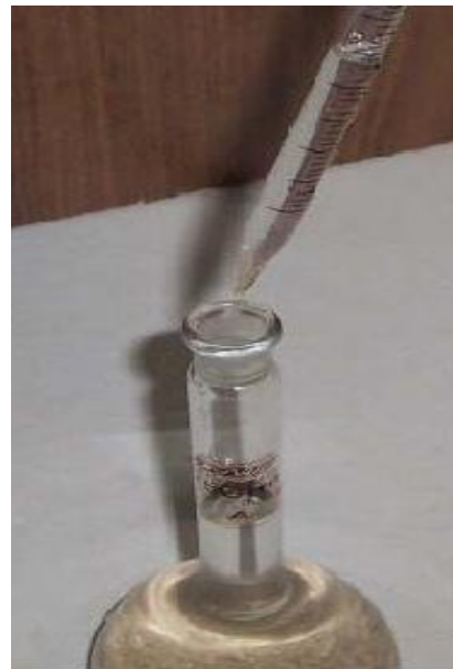
Με την χρήση του σταγονόμετρου διατηρούμε σταθερό τον όγκο και στεγνώνουμε την εσωτερική επιφάνεια της φιάλης
