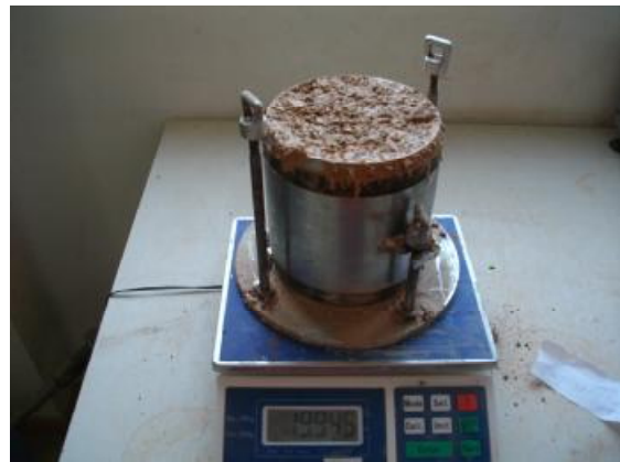
Μετά το τέλος της συμπύκνωσης ζυγίζουμε το εδαφικό υλικό μαζί με το καλούπι
