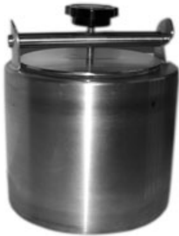
Το δοχείο της συσκευής Microdeval στο οποίο τοποθετούμε τα αδρανή, τα σφαιρίδια και το νερό
