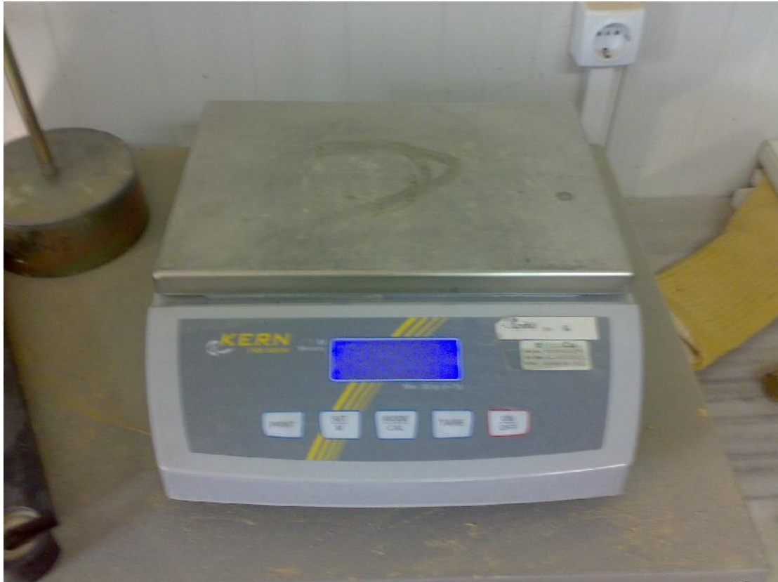
Εικόνα 2.5- Ηλεκτρονικός ζυγός ζυγιστικής ικανότητας 5,5 Kg και διακριτικής ικανότητας 0,1 gr
