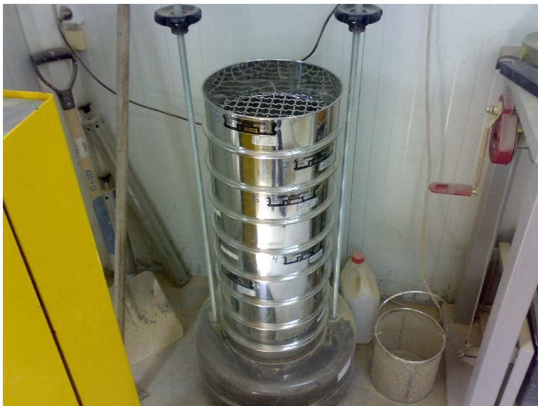
Εικόνα2.4- Πρότυπα αμερικανικά κόσκινα μαζί με μηχανή κοσκίνισματος
