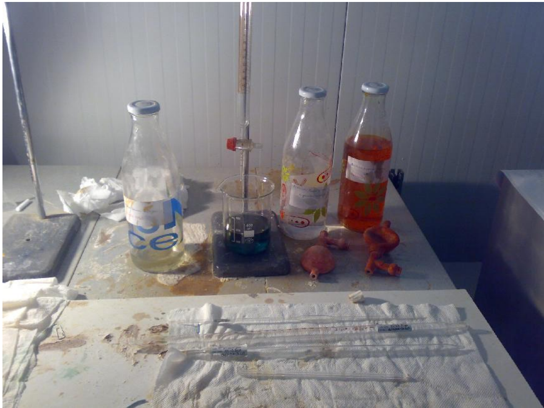
Εικόνα 2.10- Απαιτούμενος εξοπλισμός προσδιορίσμου οργάνικης ύλης (Πιπέτες 10 και 50ml,διάλυματα,προχοίδα κτλ)
