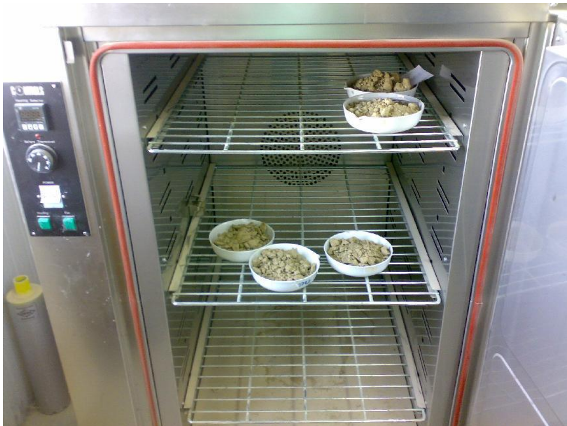
Εικόνα 2.3- Κλίβανος θερμοκρασίας 110 °C
