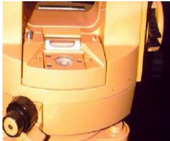
Σφαιρική και σωληνωτή ή κυλινδρική αεροστάθμη
