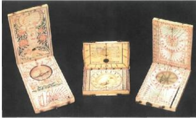
Λίπτυχο όργανο, πυξίδα με ηλιακό ρολόι ενσωματωμένο στο καπάκι, χρησιμοποιήθηκε από τους ταξιδιώτες σε συνδυασμό με τους οδικούς χάρτες
