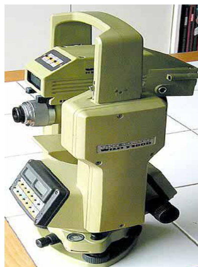
β) EDM συνδρασμένο με ηλεκτρονικό θεοδόλιχο
