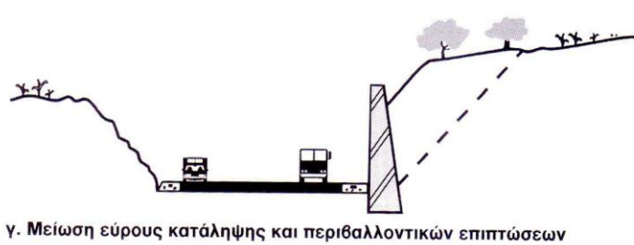
Σχήμα . Έργα αντιστήριξης στην οδοποιία.
