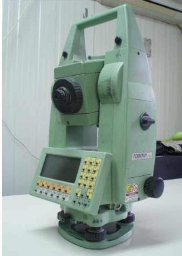
(εικόνα 12 Ο γεωδαιτικός σταθμός Leica TCRM 1101)
