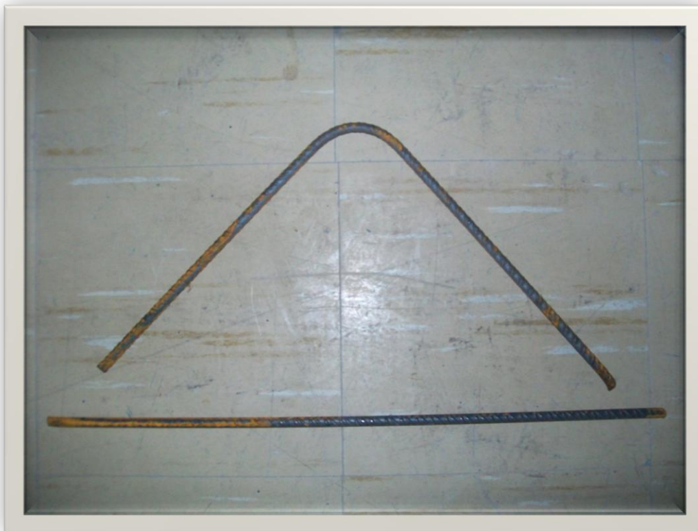
Ανάκαμψη δοκιμίου Φ10
