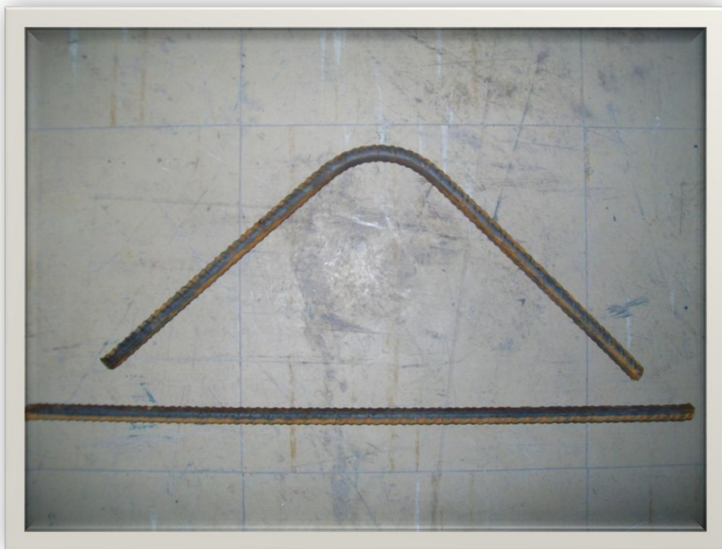
Ανάκαμψη δοκιμίου Φ14
