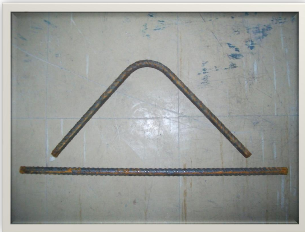
Ανάκαμψη δοκιμίου Φ16
