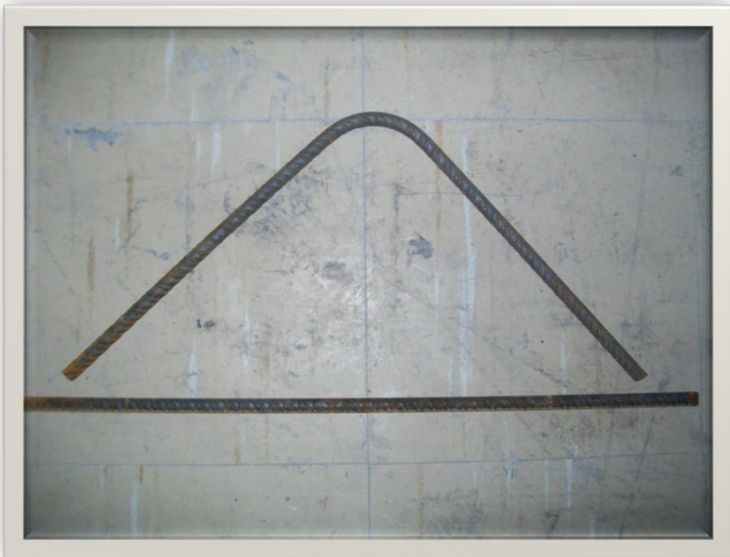
Ανάκαμψη δοκιμίου Φ12
