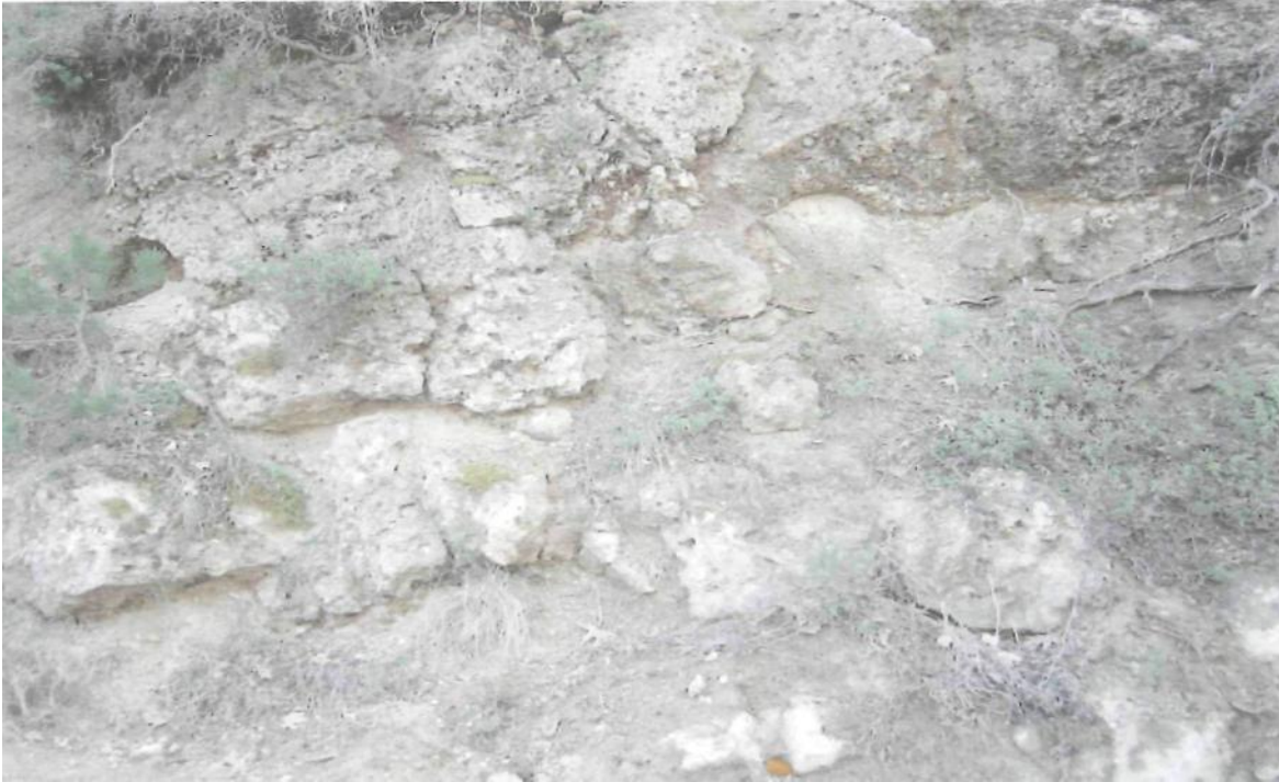
ΦΩΤΟΓΡΑΦΙΑ 12 : Χ. Θ 23+800 3ου Τμήματος Αμμούχες μάργες του Ρέθιου - Δένδρου με χαλαρά κροκαλοπαγή στη βάση τους
