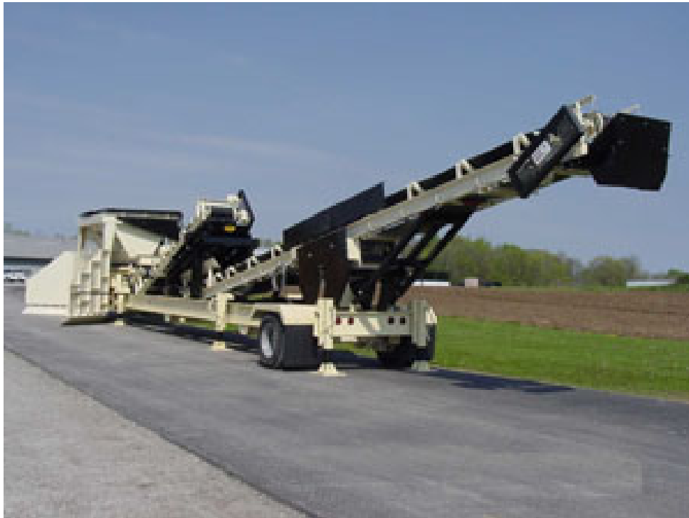
Εικόνα 36. Τυπικό μηχάνημα ανακύκλωσης εν θερμώ με δυνατότητα επαναδιάστρωσης
