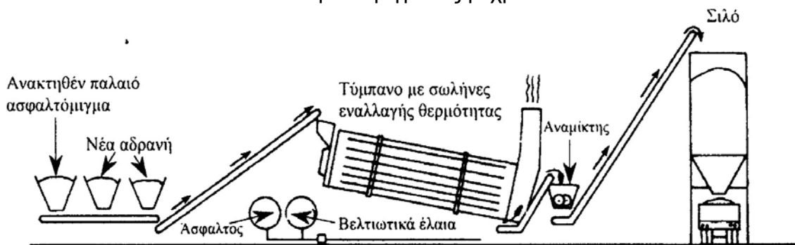
Εικόνα 44. Συγκρότημα συνεχούς ροής με έμμεση θέρμανση για την παραγωγή ανακυκλωμένου ασφαλτομίγματος
