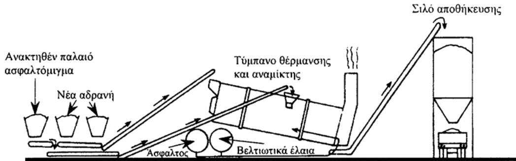
Εικόνα 43. Συγκρότημα συνεχούς ροής για παραγωγή ανακυκλωμένου ασφαλτομίγματος με τροφοδότηση στο μέσο του τυμπάνου
