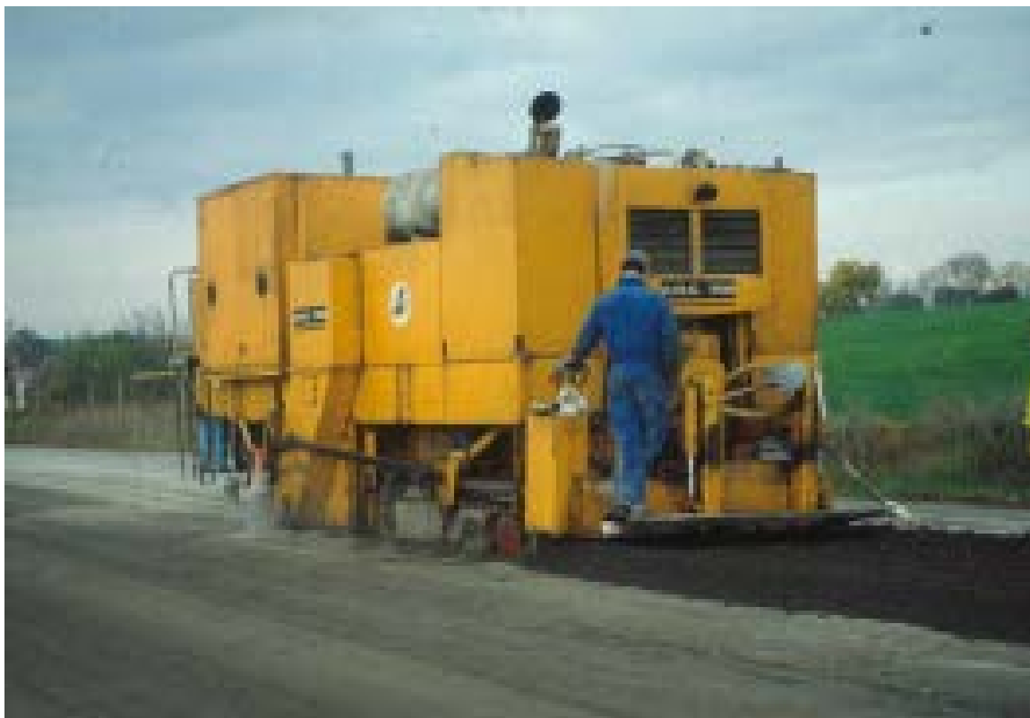
Εικόνα 46. Ειδική φρέζα με δυνατότητα ανάμιξης για ανακύκλωση της οδού εν ψυχρώ
