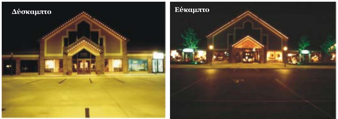
Εικόνα 6. Σύγκριση της ορατότητας τη νύχτα μεταξύ εύκαμπτου και δύσκαμπτου οδοστρώματος
