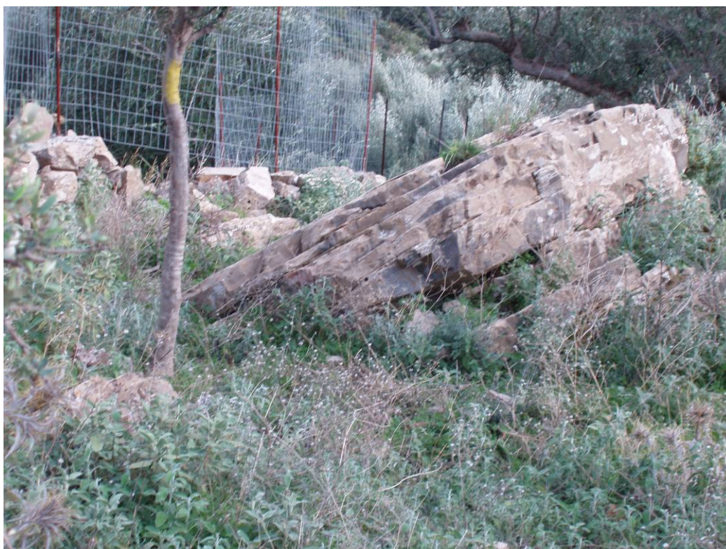
Φωτ. 6 Άποψη των κρυσταλλικών ασβεστόλιθων (Κ.κ), περί τη Χ.Θ. 2+435 της χάραξης, όπου διακρίνονται οι στρώσεις.
