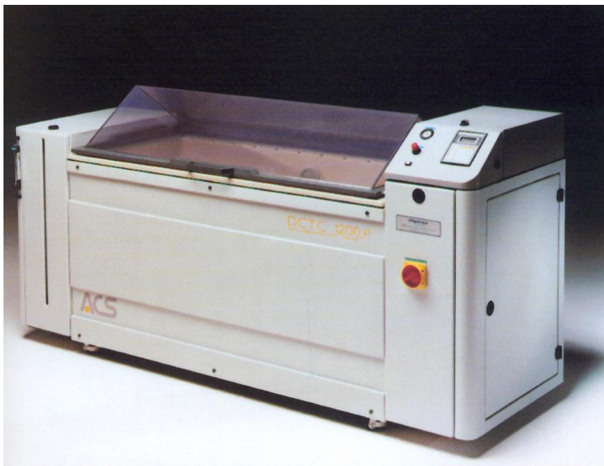
4.5.8 Θάλαμος προσομοίωσης περιβαλλοντικών συνθηκών σε ημιβιομηχανική κλίμακα-GTS 600
