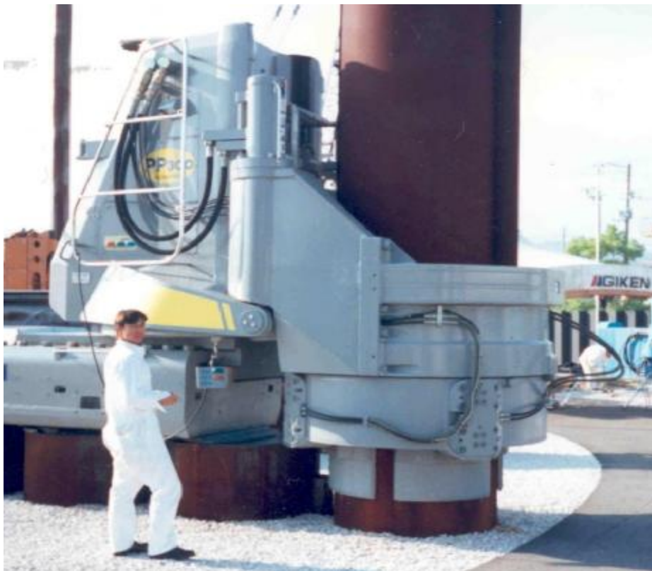
Σχήμα 2.7: Μηχανισμός σφυριού με γρύλους.
