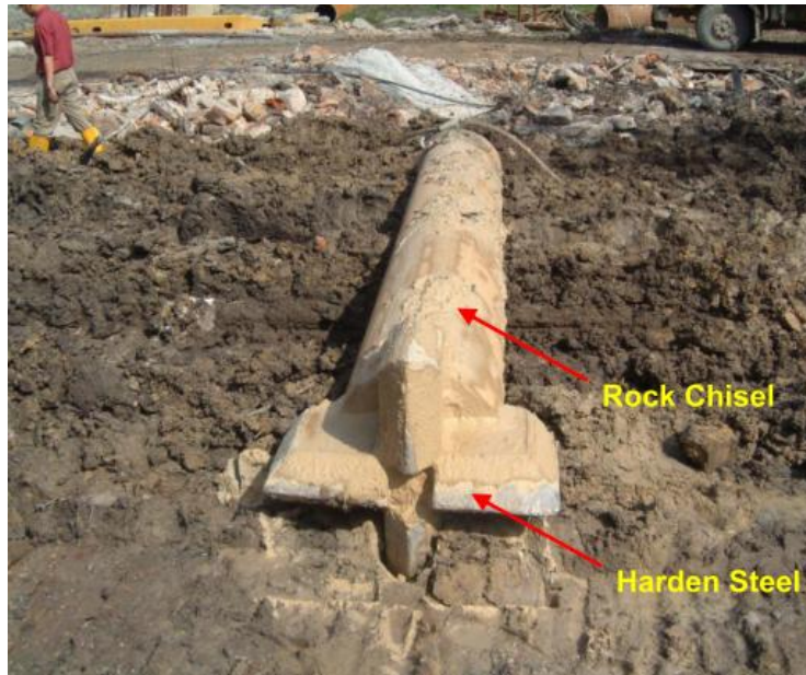
Σχήμα 2.10: Τρυπάνι από σκληρυμένο ατσάλι για την εκσκαφή σε βραχώδες υπόστρωμα.
