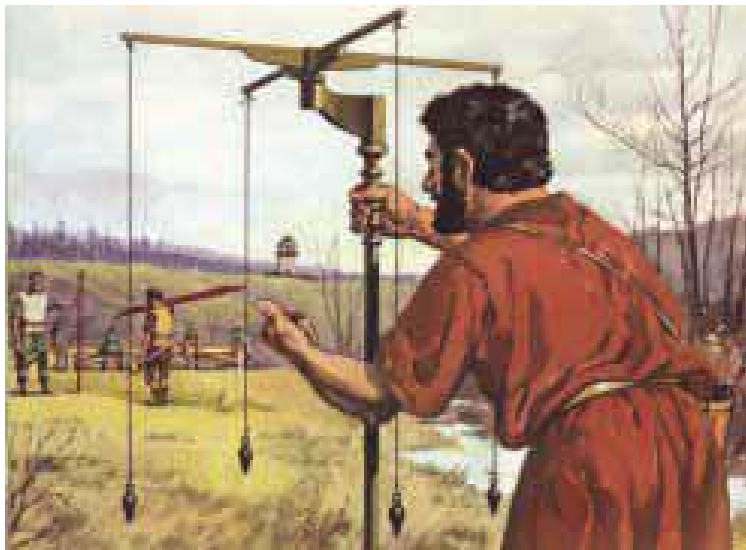
Εικόνα 1. Ο αρχαιοελληνικός «αστέρας» για τη μέτρηση και χάραξη ορθών γωνιών
