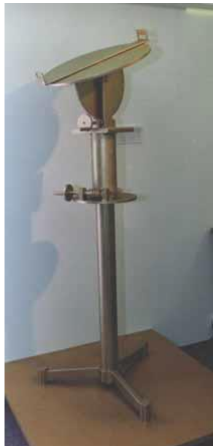
Εικόνα 7. Η Διόπτρα του Έρωνα
