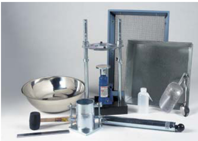
Σχήμα 2.9. Εξοπλισμός για την επίτευξη της δοκιμής συμπύκνωσης
