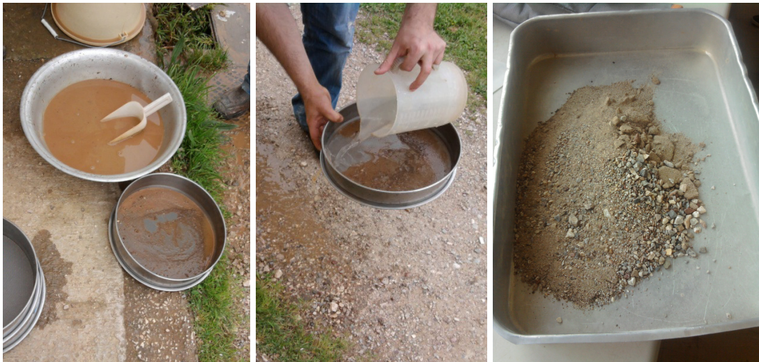
Σχήμα 2.2 Προετοιμασία δείγματος για κοκκομετρική ανάλυση με πλύση και ξήρανση
