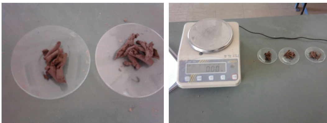
Σχήμα 2.7. Απαιτούμενος εξοπλισμός προσδιορισμού ορίου πλαστικότητας
