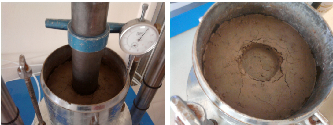
Σχήμα 2.12. Διείσδυση εμβόλου κατά τη δοκιμή CBR
