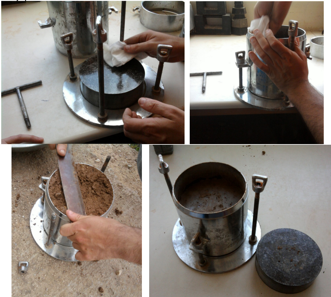
Σχήμα 2.10. Προετοιμασία και συμπύκνωση του δοκιμίου στη μήτρα Proctor
