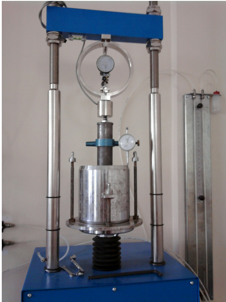
Σχήμα 2.11. Εξοπλισμός για την εκτέλεση της δοκιμής CBR
