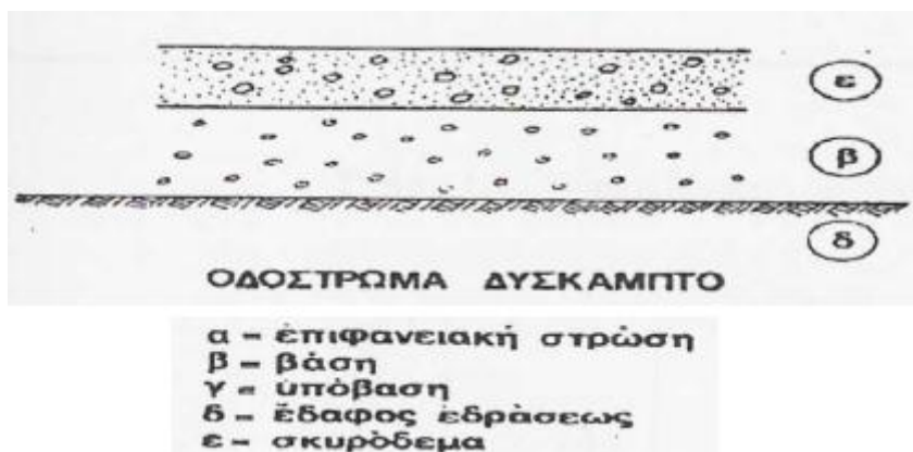
Εικόνα 1.4: Χαρακτηριστική δομή δύσκαμπτου οδοστρώματος
