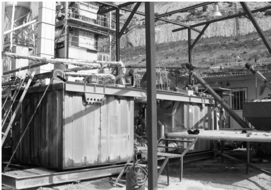
Εικόνα 3.3.1: Παραγωγή τροποποιημένης ασφάλτου ισοπεδωτικής στρώσης ασφάλτου
