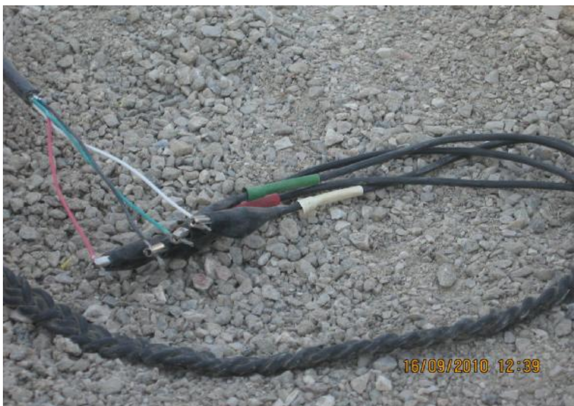
Εικόνα 20: Σύνδεση οργάνου με την συσκευή καταγραφής μετρήσεων
