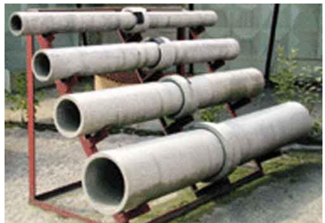
Φωτο 7. Σωλήνες αμιαντοτσιμέντου
