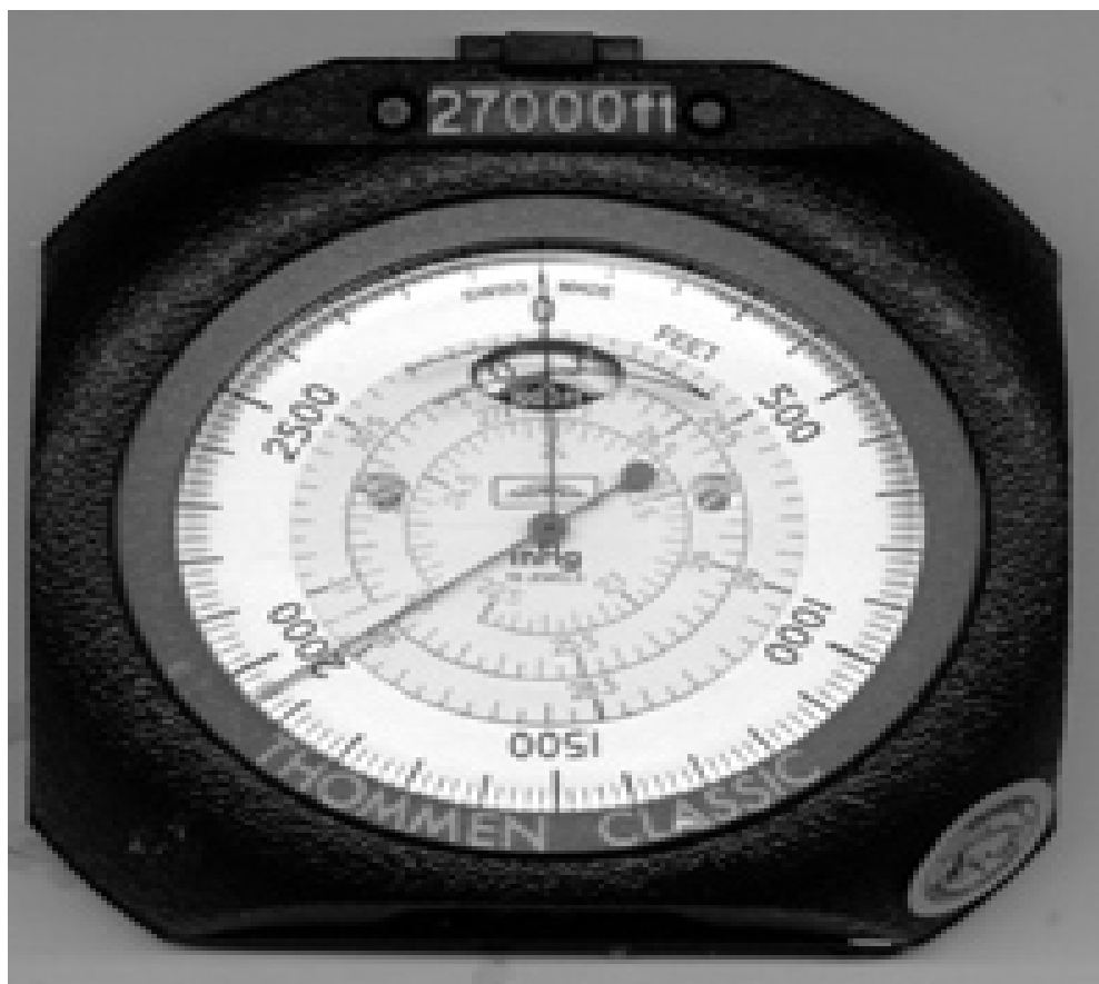
Σχ.2.6 Σύγχρονο βαρόμετρο – αλιμέτρο. ( τιμή της τάξης των 400 – 500 Ευρώ )
