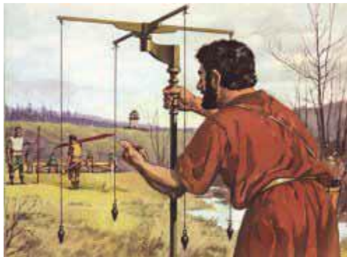
Σχ. 1.3. Ο αρχαιοελληνικός «αστέρας» για τη μέτρηση και χάραξη ορθών γωνιών
