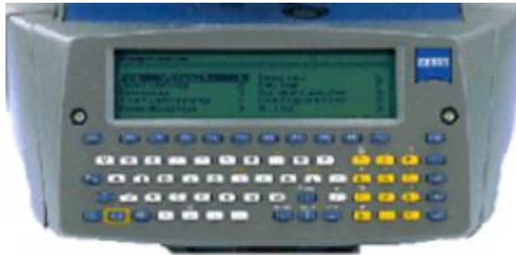
Σχ. 3.6. Οθόνη αναγνώσεων σε ηλεκτρονικό θεοδολίχο
