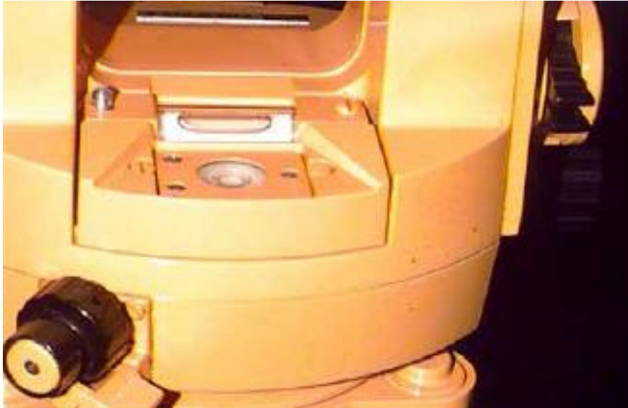
Σχ. 3.4. Σφαιρική και σωληνωτή ή κυλινδρική αεροστάθμη
