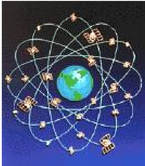
Σχ. 3.17. Το δορυφορικό τμήμα του GPS
