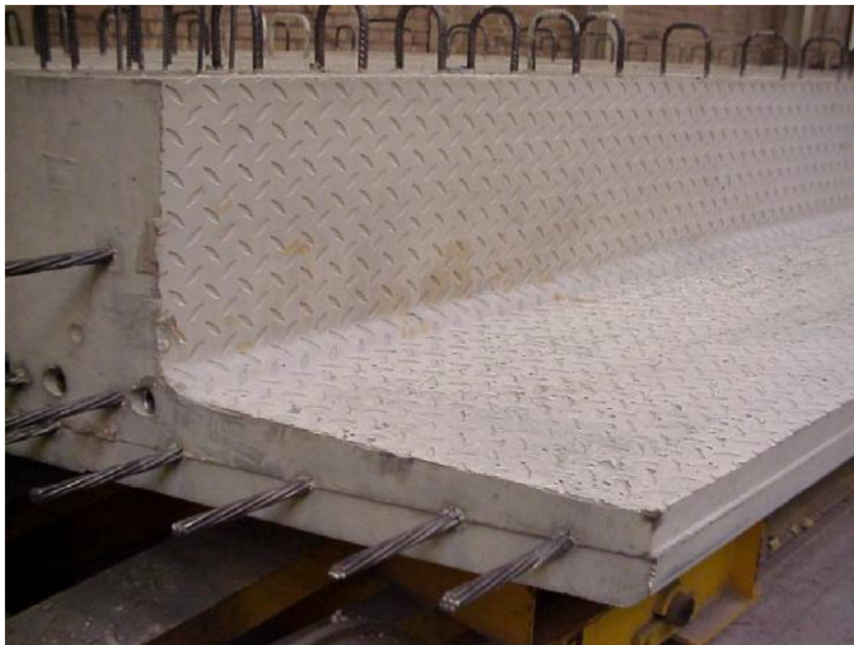
Εικόνα 17 Αυτοσυμπυκνούμενο σκυρόδεμα με ίνες από χάλυβα
