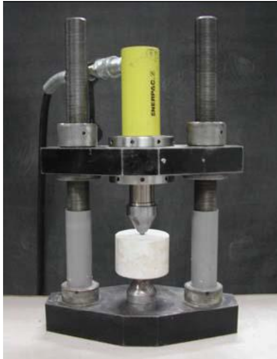
Εικόνα 31. Δοκιμή σημειακής φόρτισης, αξονική
