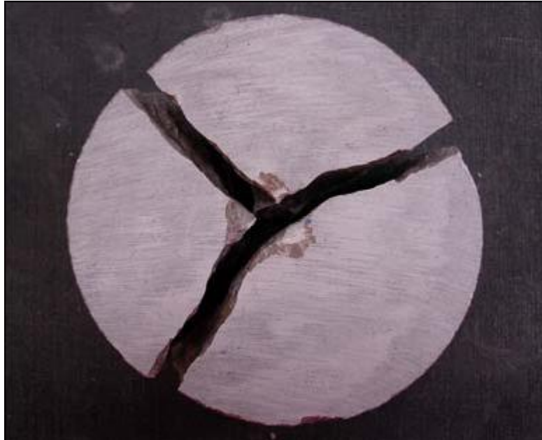
Εικόνα 34. Αντιπροσωπευτικά δοκίμια μετά την αστοχία από αξονική δοκιμή
