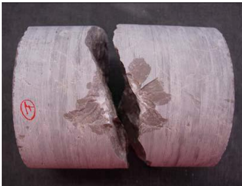
Εικόνα 33. Αντιπροσωπευτικά δοκίμια μετά την αστοχία από διαμετρική δοκιμή
