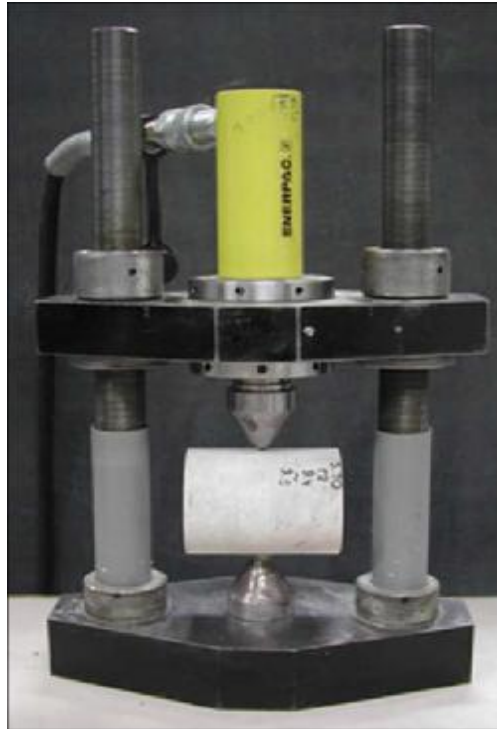
Εικόνα 32. Δοκιμή σημειακής φόρτισης, διαμετρική
