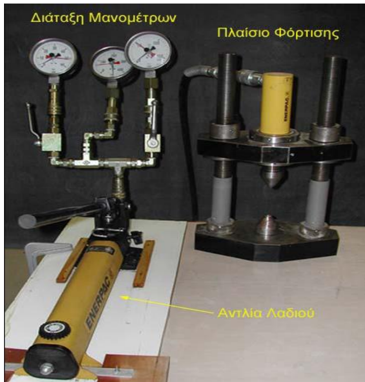
Εικόνα 29. Χειροκίνητη συσκευή φόρτισης για την εκτέλεση δοκιμών σημειακής φόρτισης
