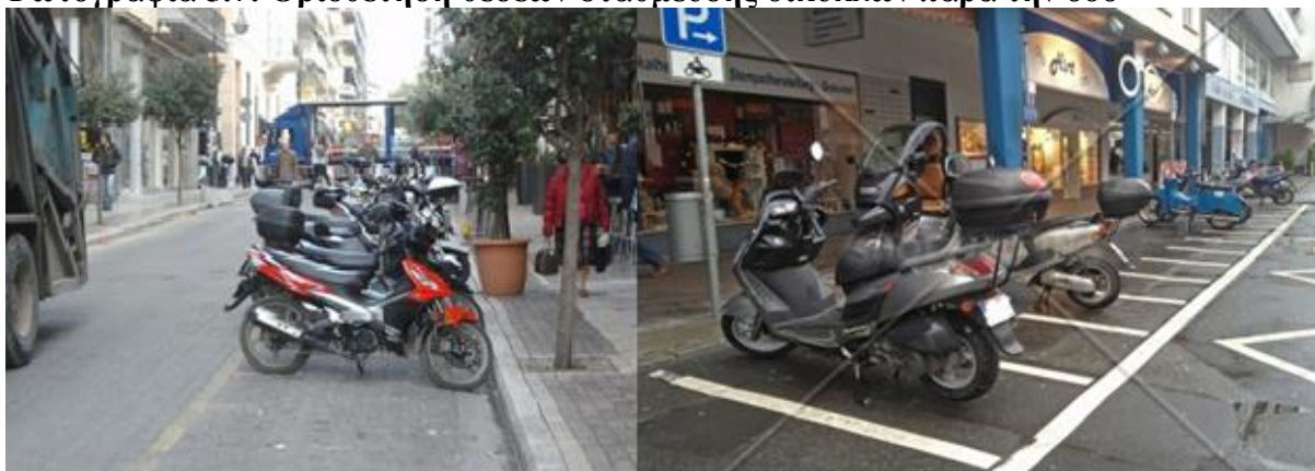
Φωτογραφία 5.7: Οριοθέτηση θέσεων στάθμευσης δίκυκλων παρά την οδό
