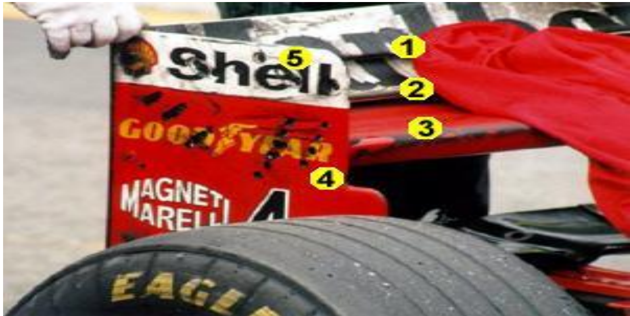
Εικόνα 30.Πίσω φτερό ενός σύγχρονου μονοθεσίου με 3 αεροδυναμικά στοιχεία(1, 2, 3).γραμμές από τρύπες για την προσαρμογή στη γωνία επίθεσης(4) και εγκατάσταση ενός άλλου στοιχείου είναι ορατό στην τελική πλάκα του φτερού(5)
