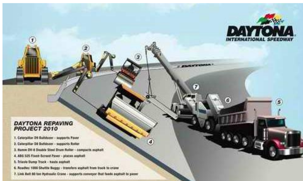
Εικόνα 77. 1. Προωθητής Caterpillar D9 - ανάρτηση του finisher 2. Προωθητής Caterpillar D8 - ανάρτηση του οδοστρωτήρα 3. Δονητικός οδοστρωτήρας Hamm DV - 8 με χαλύβδινα τύμπανα μπρος και πίσω 4. Finisher ABS 25 με σταθερό πήχυ επιπέδωσης 5. Τριαξονικό φορτηγό ανατρεπόμενο 6. Ταινιοφόρος τροφοδότης Roadtec 1000 για την προώθηση του ασφαλτοσκυροδέματος στο finisher 7. Γερανός Link Belt για την υποβοήθηση του τροφοδότη
