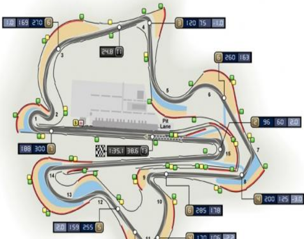
Εικόνα 22. Πίστα Σεπάνγκ - στροφές και συνδυασμός ταχύτητας σε αναλογία σχέσεων κιβωτίου
